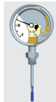
Variazioni della temperatura ambiente agenti sulla cassa sono compensate tramite un elemento bimetallico montato fra il movimento ed il tubo bourdon.
