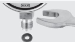
Pour assurer l'étanchéité du raccord avec filetage cylindrique du manomètre sur la surface d'étanchéité ① il faut utiliser des joints plats, des joints forme lentille ou les joints à écrasement WIKA. Pour les filetages coniques (par exemple filetage NPT) l'étanchéité sur le filetage ② se fait en utilisant en plus un matériau d'étanchéité comme par exemple la bande PTFE (selon EN 837-2).
