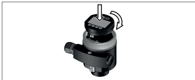
Fig. 32: Montage du module d'affichage et de réglage dans le boîtier à chambre unique se trouvant dans le compartiment de l'électronique
