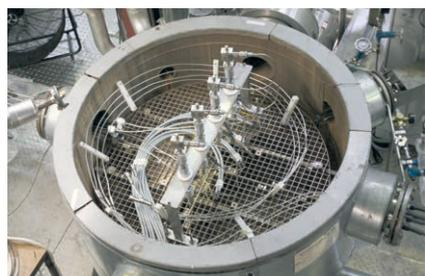
Essai de perte de réfrigérant par APRP (essai d'accident avec perte de réfrigérant)
