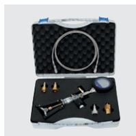
La combinaison de l'afficheur numérique de densité de gaz de précision compensé en température type GDI-100-D et de la pompe de test permet un réglage précis du point de mesure et la représentation de valeurs de mesure dans différentes unités. La température extérieure et les fluctuations de pression n'affectent pas la mesure. Le système d'étalonnage type BCS-10 est livré dans une mallette robuste en plastique.
