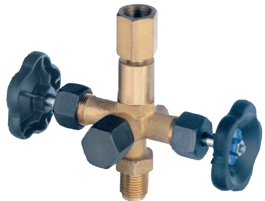
Robinet d'isolement avec raccord pour test séparé selon DIN 16272, écrou de serrage LH/RH / mâle G 1/2, avec pivot de test M20 x 1,5, PN 400
