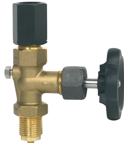
Robinet d'isolement selon DIN 16270, Ecrou de réglage LH-RH / mâle G 1/2, PN 250
