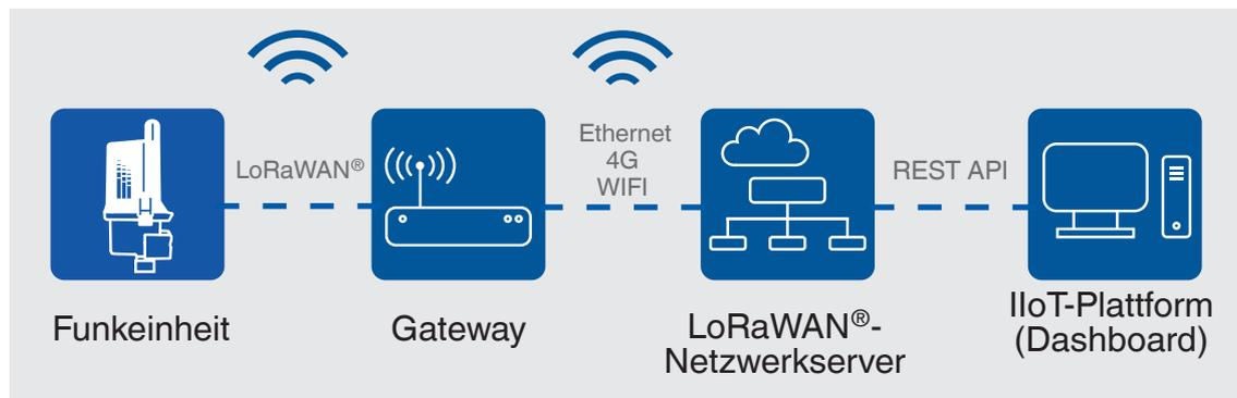
Daten von einem Messgerät mit 4 ... 20 mA Signal, werden mit einem Kabel an die Funkeinheit und weiter über Funk zum Gateway übertragen. Es wird sichergestellt, dass nur autorisierte Endgeräte mit dem Netzwerkserver kommunizieren dürfen. Dafür ist das Messgerät vorab mit dem Netzwerkserver zu koppeln. Im LoRaWAN® kann die Funkübertragung bis zu 10 km [6 mi] betragen. Die Reichweiten sind abhängig von Faktoren wie der Topografie, der Platzierung des Gateways und Umwelteinflüssen.
