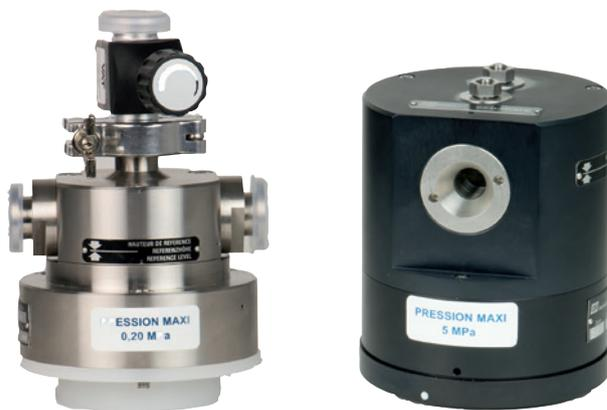
Cabezales de medición para presión absoluta y relativa
