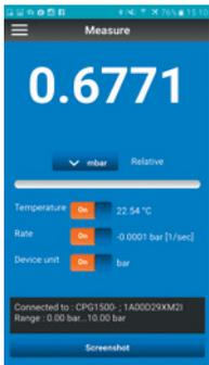
通过“myWIKa device” app 和 WIKa-Wireless连接，仪表能够轻松地通过一部手机进行日志程序配置。在密度测量过程中，数值能够直接以所需的单位显示在手机上。且可读取更多数据，如温度和压力。用户也可以从威卡（WIKa）网站上检索更详细的仪表信息。此外，该app允许配置、控制和保存日志程序。被保存在手机上的日志可以被转移到电脑上，并根据需要进行处理。
