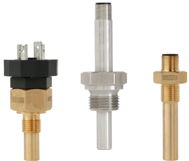
Rys. lewy: przyłącze kątowe wg DIN EN 175301-803 Rys. środkowy: przyłącze okrągłe M12 x 1 z szyjką przedłużeniową Rys. prawy: przyłącze okrągłe M12 x 1
