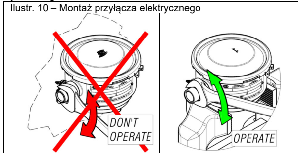
Ilustr. 10 – Montaż przyłącza elektrycznego
